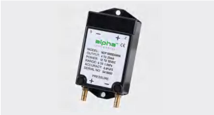
Model 162 系列微差压传感器的核心部件是一个电容式压力敏感元件，由不锈钢膜片与固定电极构成一个电容，其值随压力变化而变。采用本公司特殊专利技术精心设计的传感器敏感元件和独特的检测电路确保了产品良好的温度性能和长期稳定性。
